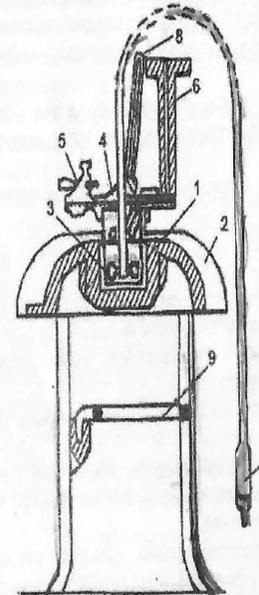
Прибор Мартенс-Пенского: 1 – чугунный сосуд; 2 – рубашка; 3 – цилиндрический омедненный резервуар; 4 – крышка; 5 – фитильное устройство; 6 – пружинный рычаг; 7 – мешалка; 8 – термометр; 9 – электроплитка
