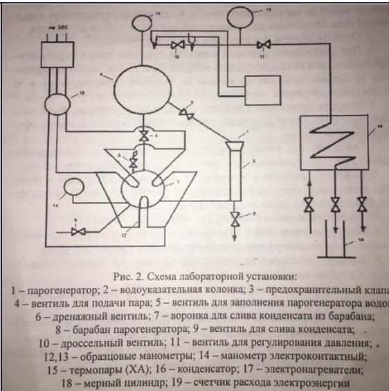
3. При достижении заданной величины давления пара в парогенераторе постепенно начать открывать вентили 10 и 11 так, чтобы прекратились пульсации давления на выходе из барабана парогенератора и за дроссельным клапаном.
