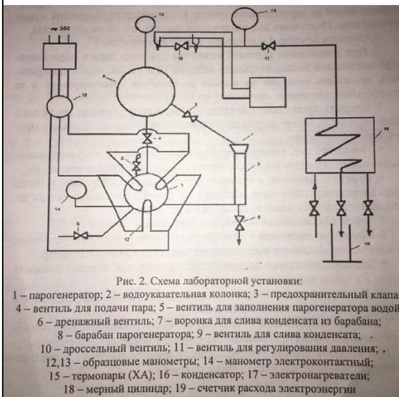
Рис. 2. Схема лабораторной установки:
