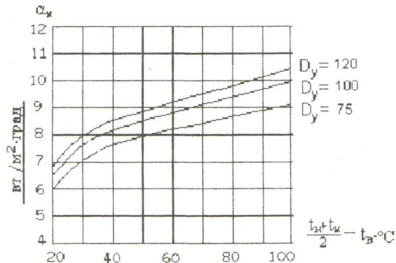
Рисунок 2. Коэффициент теплоотдачи конвекцией для горизонтальных труб
