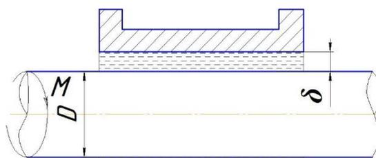
заполнен маслом, толщина слоя которого равна  $\delta$ . Диаметр вала  $D$ , длина втулки  $L$ . Вал вращает-момента  $M$ . Определить частоту вращения
