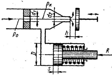
При изменении зазора  $h$  между соплом и заслонкой изменяется давление  $p_k$  вызывая следящее перемещение поршня.
