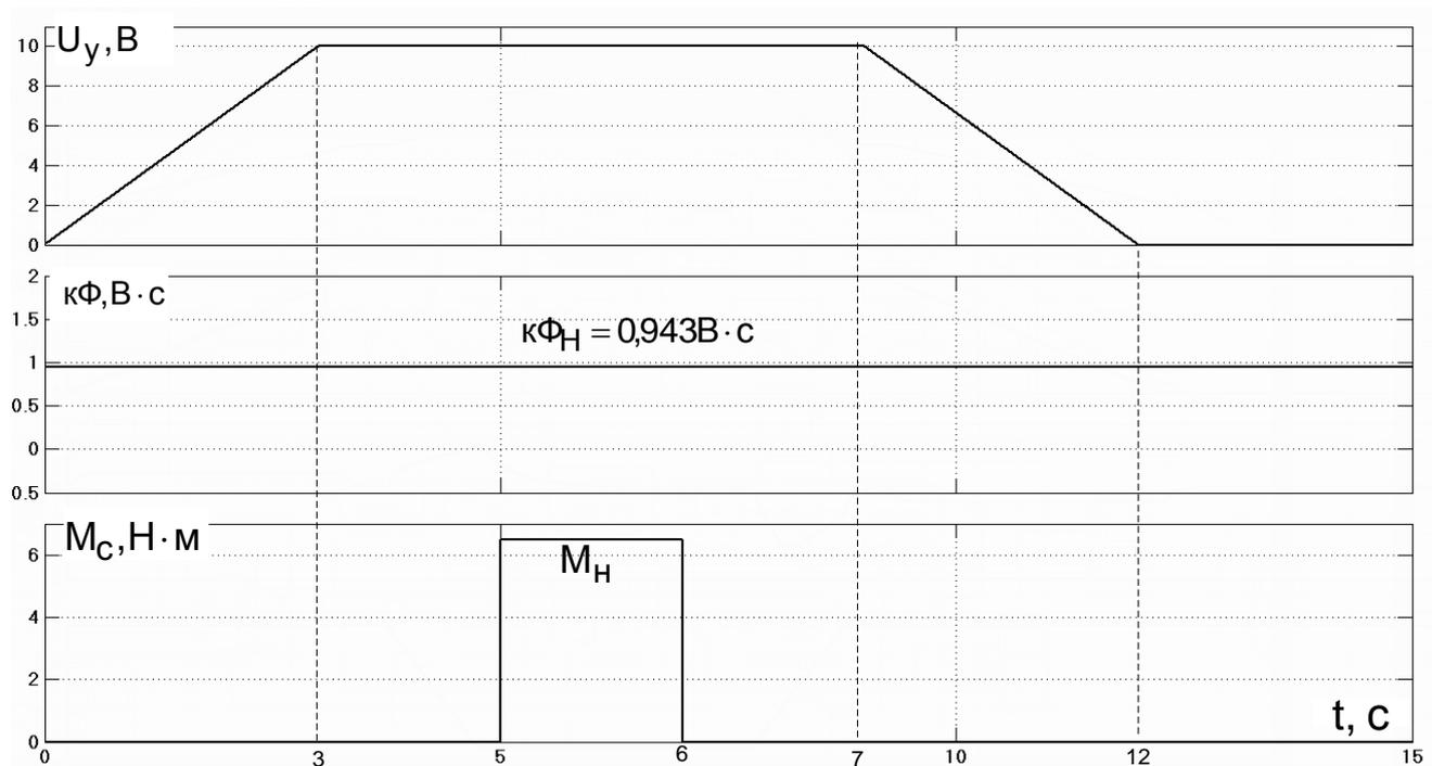
Рис. 2.32. Сигналы задания привода с ударным приложением статического момента
