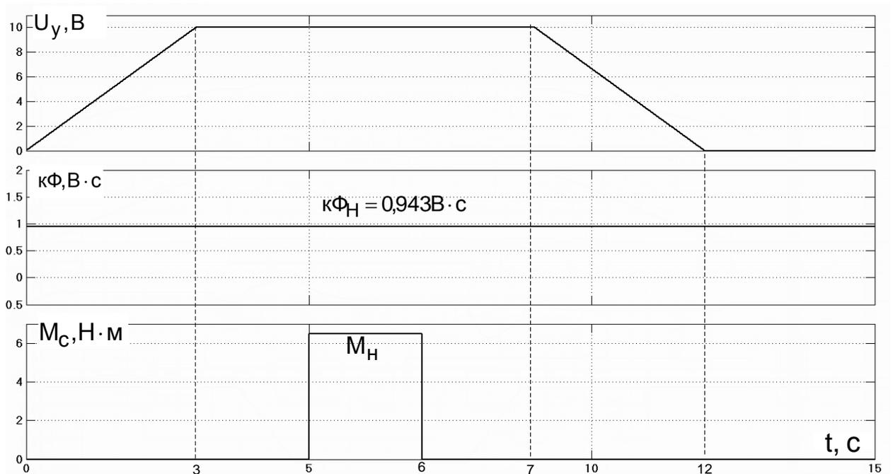
Рис. Сигналы задания привода с ударным приложением статического момента
