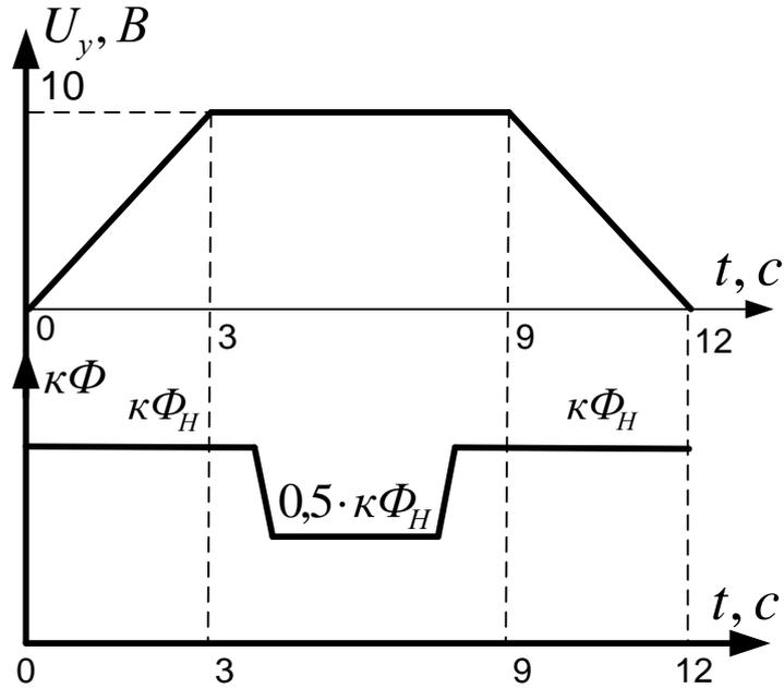
Рис. Управляющие сигналы напряжения управления ТП и номинального потока двигателя при ослаблении потока до  $0,5 \cdot k\Phi_H$
