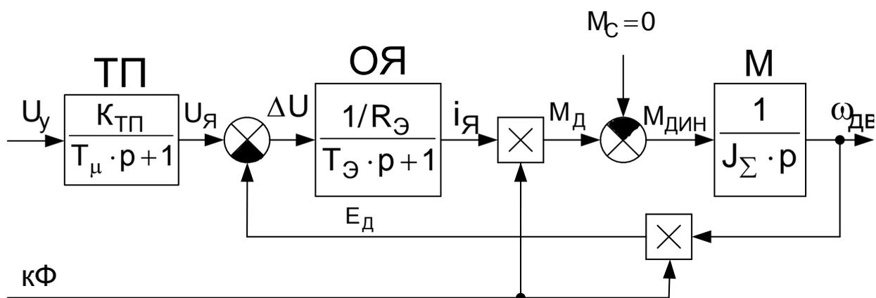
Рис. 2.16. Структурная схема системы ТП - Д
