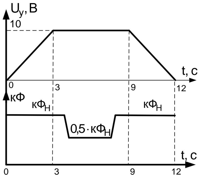
Рис. 2.20. Управляющие сигналы напряжения управления ТП и номинального потока двигателя при ослаблении потока до  $0,5 \cdot k\Phi_N$
