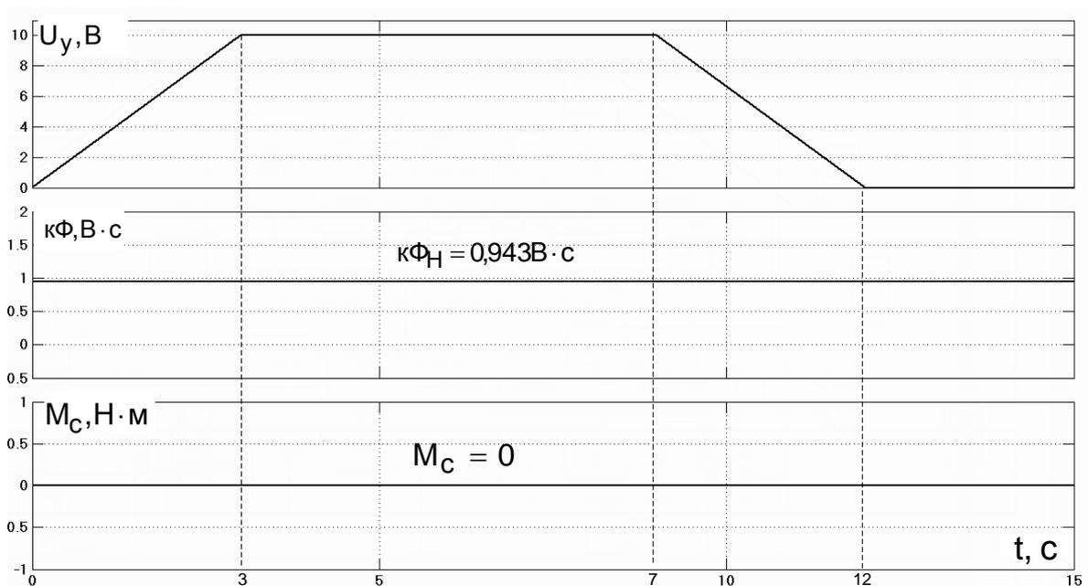
Рис. 2.28. Сигналы задания для привода в режиме x/x
