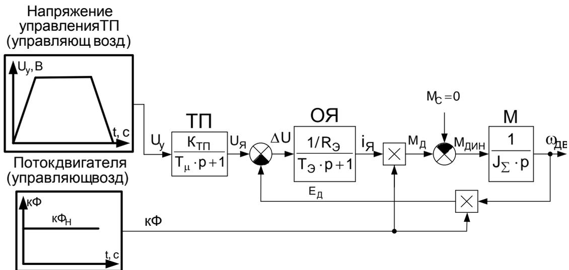
Рис. 2.17. Разгон и торможение двигателя на х/х
