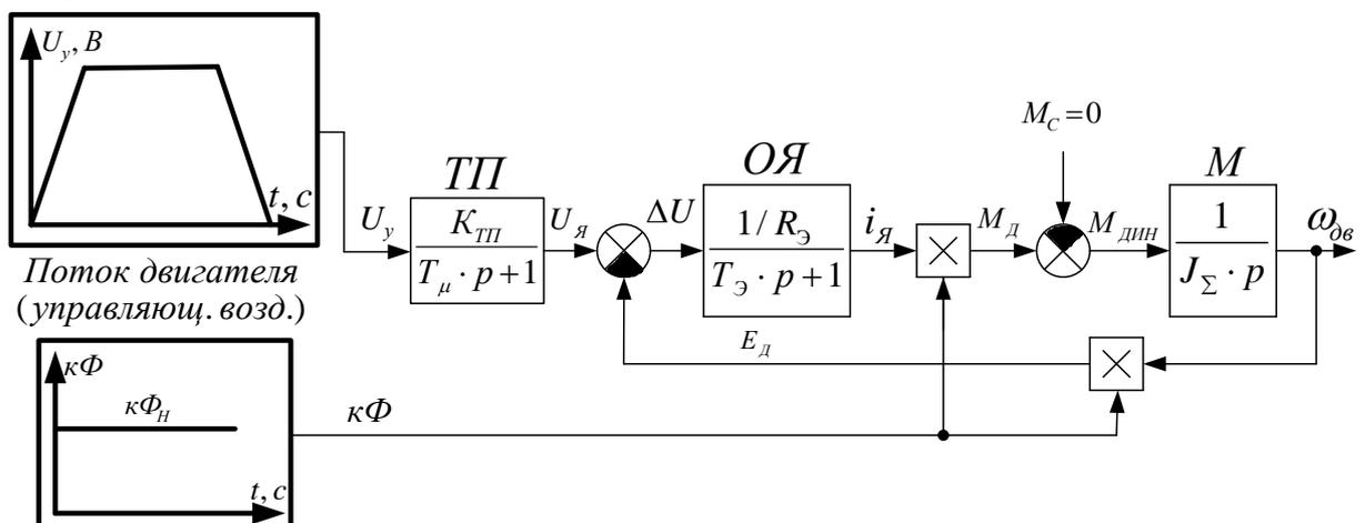
Рис. Разгон и торможение двигателя на  $x/x$
