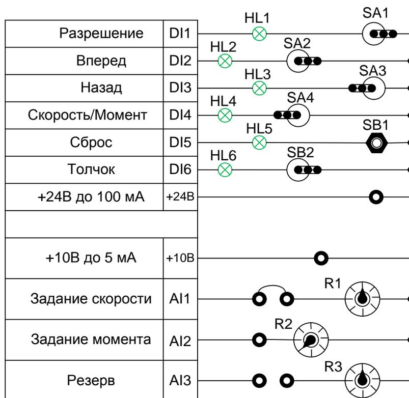
Рис. 3. Панель команд частотного преобразователя UF1
