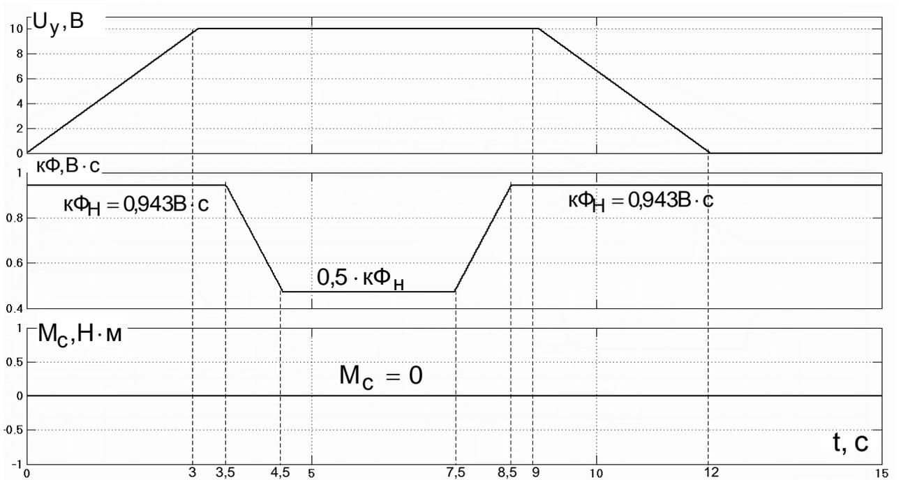
Рис. 2.30. Сигналы задания привода в режиме х/х с ослаблением магнитного потока
