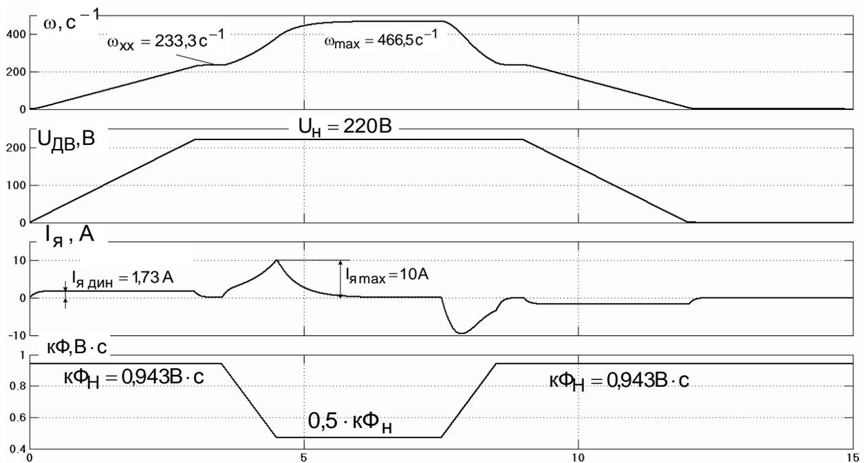
Рис. Переходные процессы привода в режиме х/х в первой и второй зоне регулирования скорости
