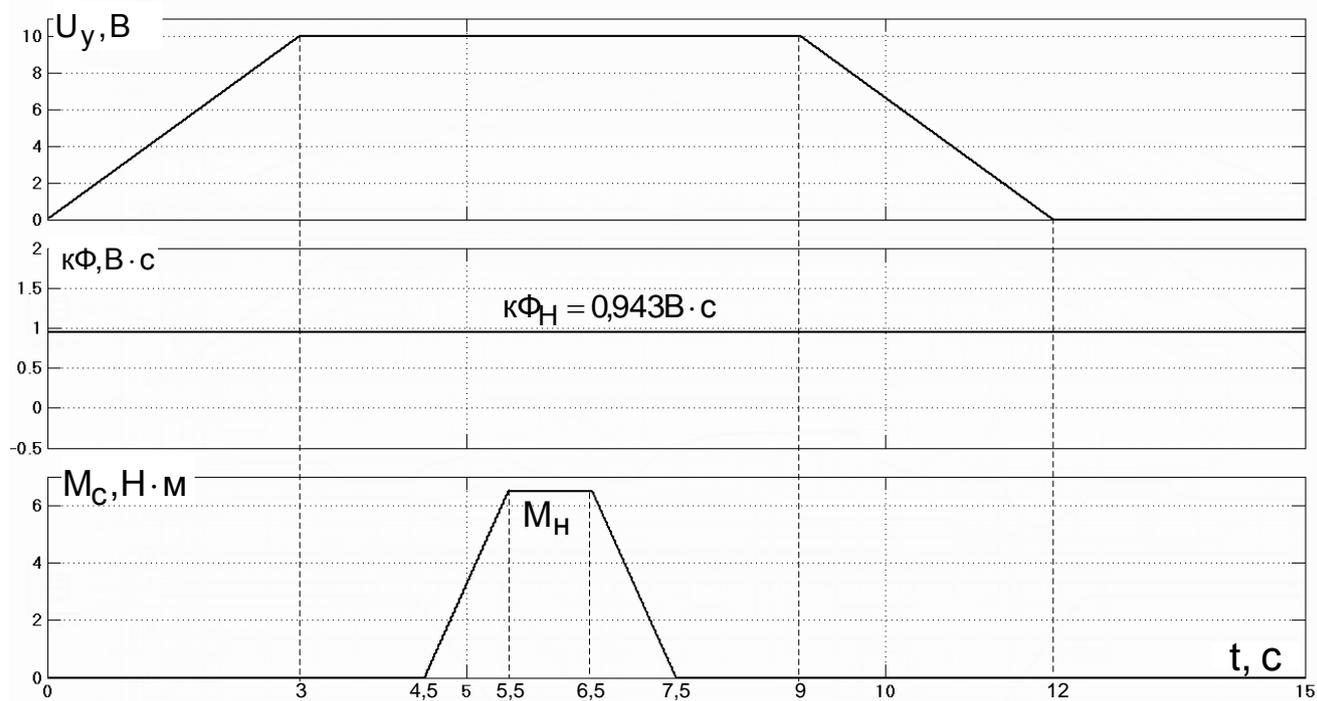
Рис. 2.36. Сигналы задания привода с линейным характером статического момента
