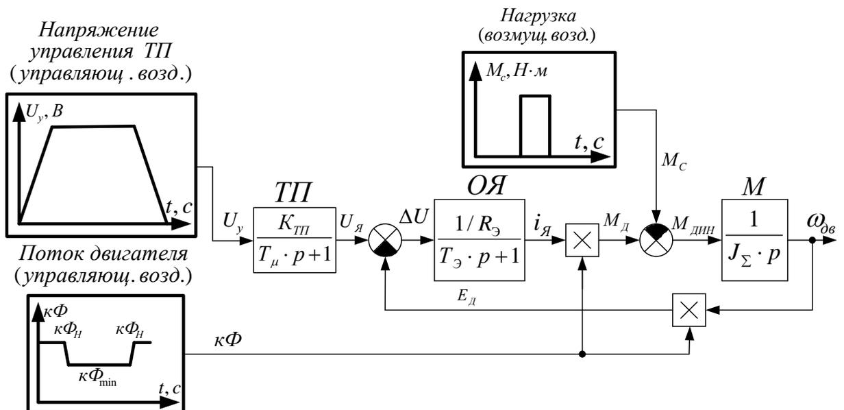
Рис. Разгон, работа и торможение двигателя с применением скачкообразной статической нагрузки при ослабленном магнитном потоке
