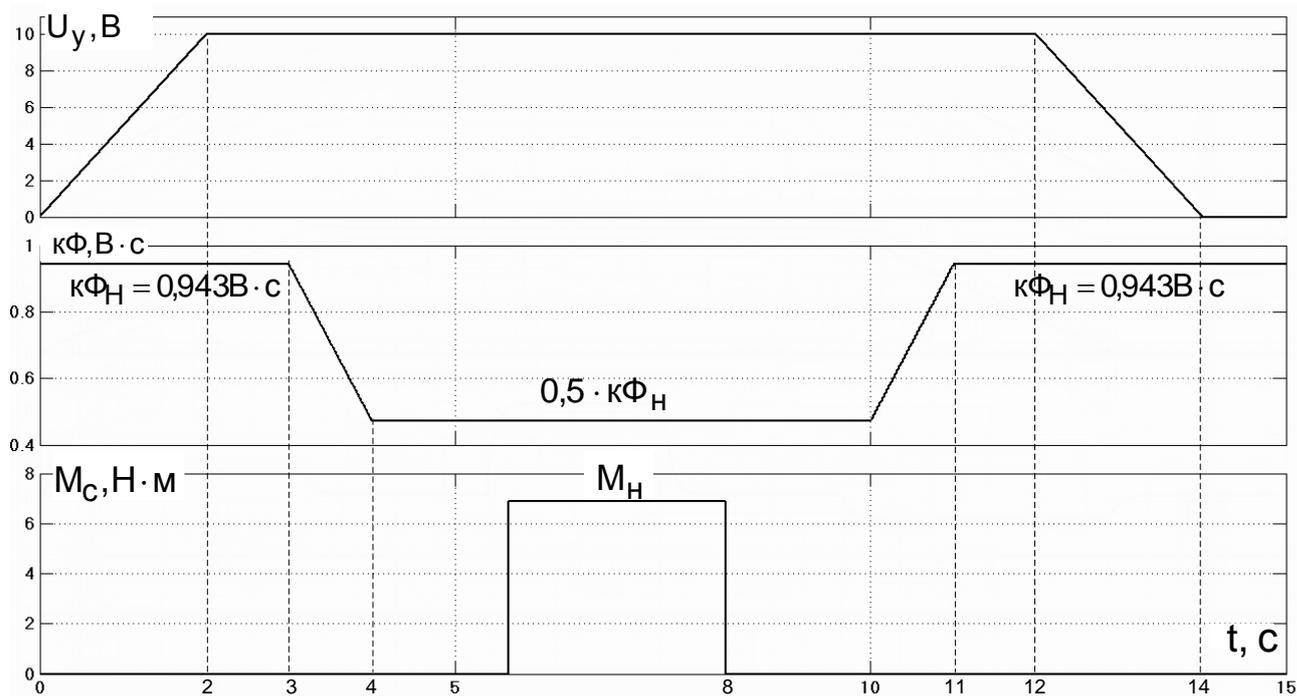
Рис. 2.34. Сигналы задания привода с ударным приложением статического момента с ослабленным магнитным потоком
