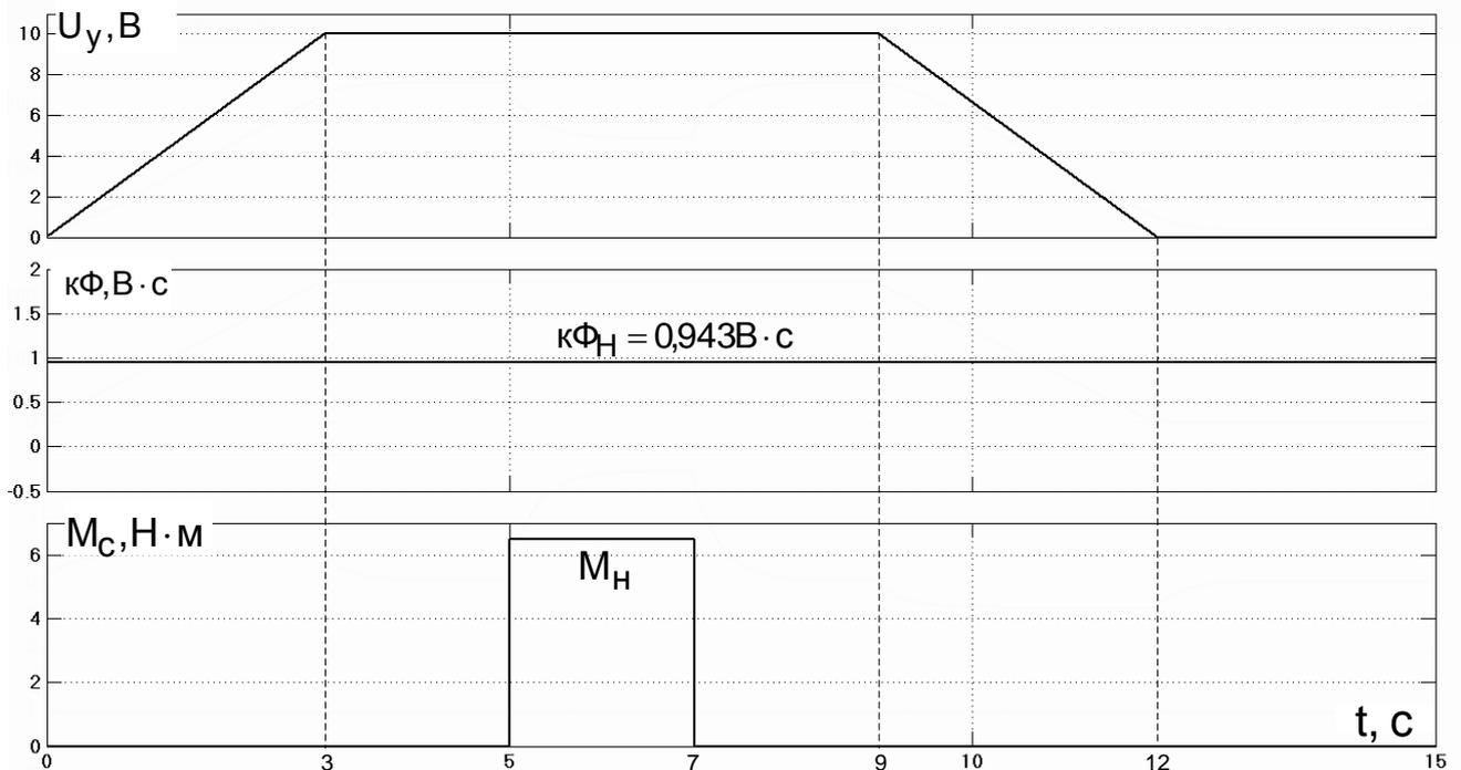
Рис. 2.38. Сигналы задания привода с ударным приложением статического момента и добавочным сопротивлением в якорной цепи  $R_{\text{d}\Sigma} = R_{\text{d1}} + R_{\text{d2}} = 8 \text{Ом}$
