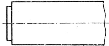
2. По данному условному обозначению вычертить шпильку и нанести размеры Шпилька  $M42 \times \frac{4.5}{3} \times 80.58$  ГОСТ 22034-76.
