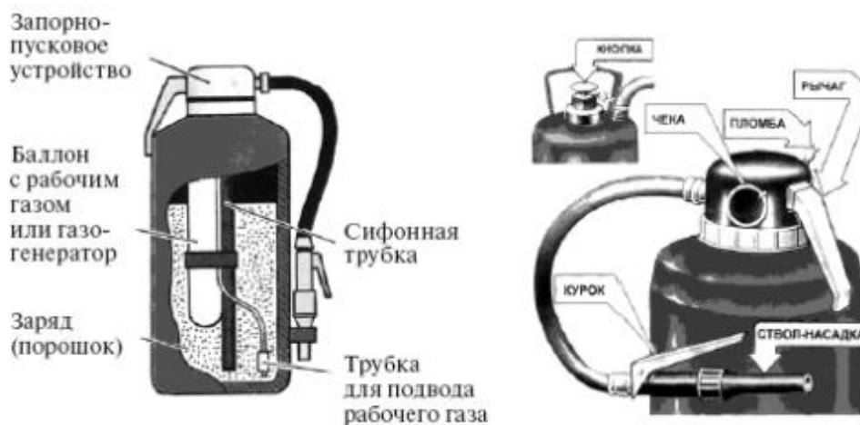
Рис. 3. Порошковый огнетушитель со встроенным газовым источником давления ОП-5
