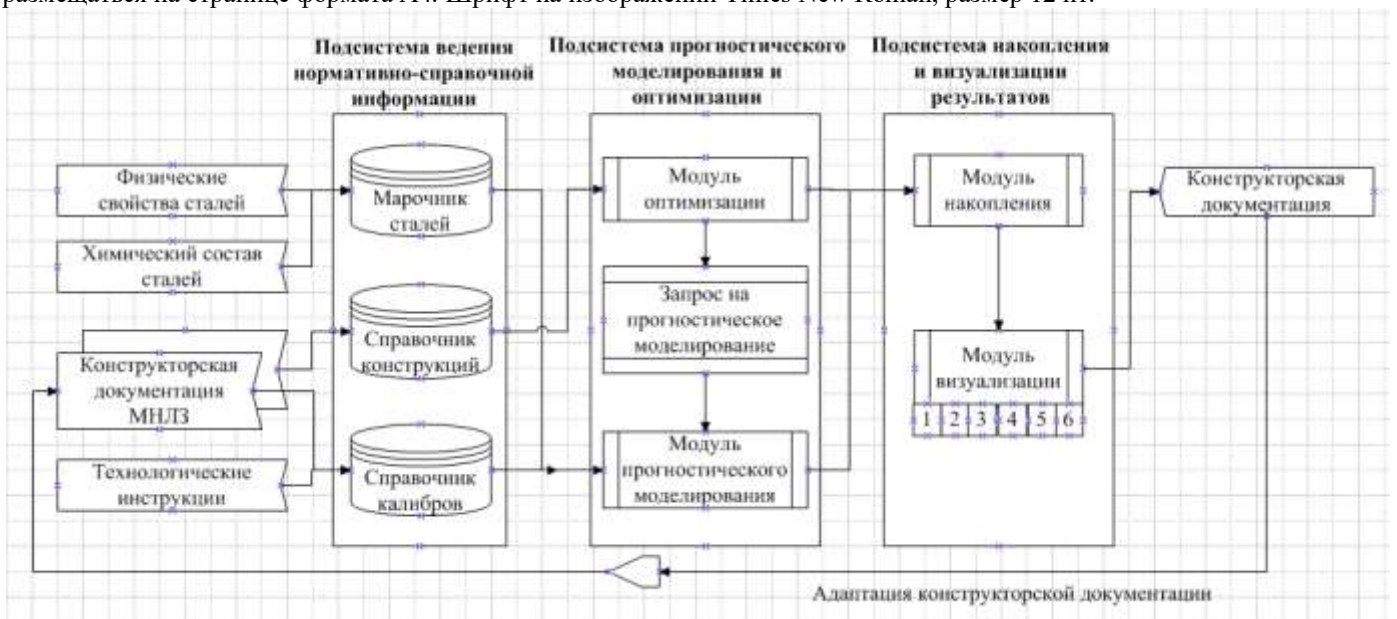
Рис. 5. Схема построения системы автоматизации проектирования
