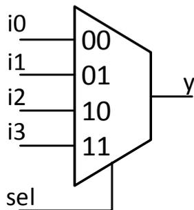
Рисунок 2.6 – Схема мультиплексора 4 в 1
