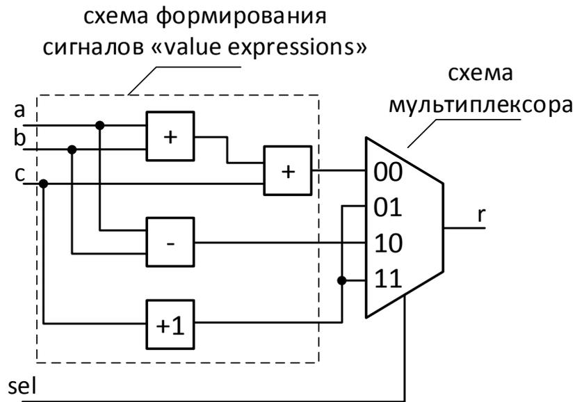
Рисунок 2.5 – Синтезированная схема, реализующая конструкцию «присваивание по выбору»
