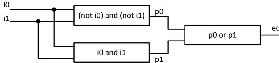
Рисунок 1.1 – Графическое представление реализации одноразрядной схемы сравнения
