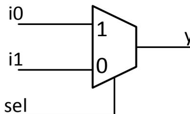
Рисунок 2.3 – Схема мультиплексора 2 в 1
