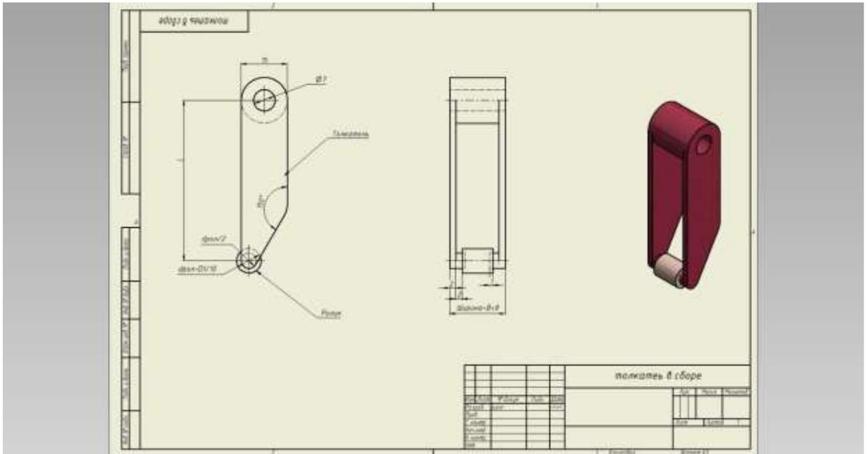
Рисунок 3. Чертеж толкателя с параметрическими зависимостями
