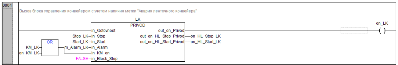
Рис. 15. Фиксация аварии ленточного конвейера
