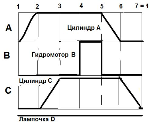
**Задание 2.** Согласно заданной диаграммы перемещения разработать системы управления: 1 - используя релейно-контактные схемы; 2 - используя (симулятор) контроллера в программе FluidSim-H.
