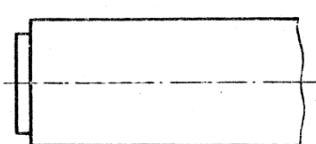
2. По данному условному обозначению вычертить шпильку и нанести размеры Шпилька М42x $\frac{45}{3}$  x 80. 58 ГОСТ 22034-76.
