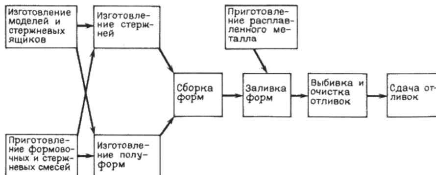
Схема технологического процесса изготовления отливок в песчаных формах
