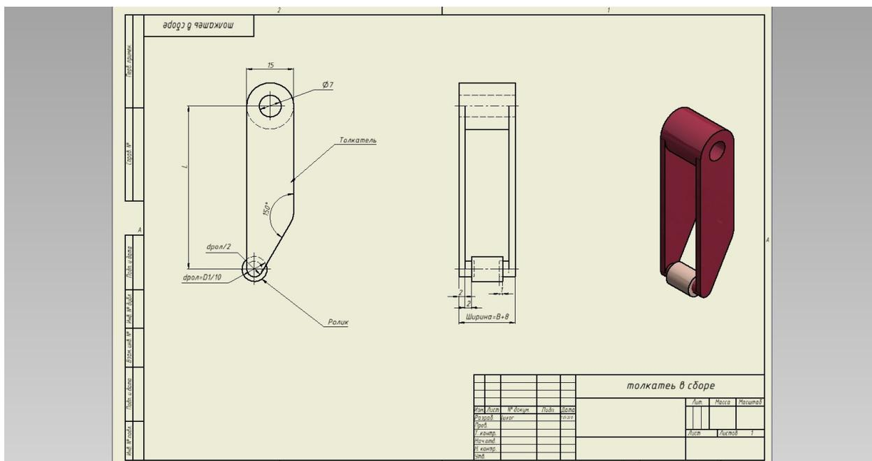
Рисунок 3. Чертеж толкателя с параметрическими зависимостями
