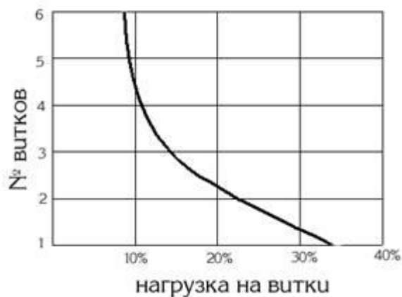
Рис. 1. График распределения нагрузки по виткам резьбы M24x3
