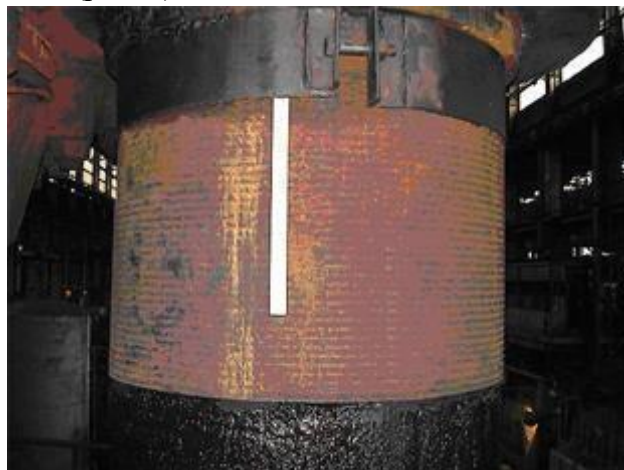
Рис. 3. Разрушение внешней резьбы шенной внутренней резьбы колонны под основанием пресса силой 100 архитравом пресса силой 100 МН для объ- МН для изготовления ж/д колес. Диаметр емной штамповки. Диаметр колонны 800 колонн 830 мм мм
