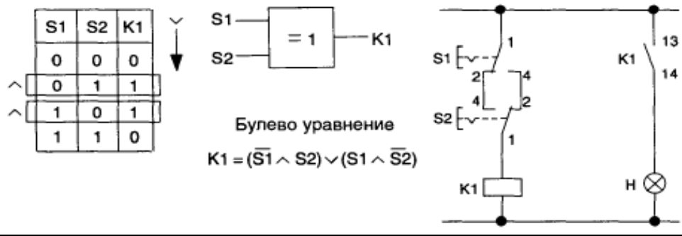
Электрогидравлическая схема с применением логической функции «исключенное «ИЛИ» в схеме (функция НЕ ИЛИ)»
