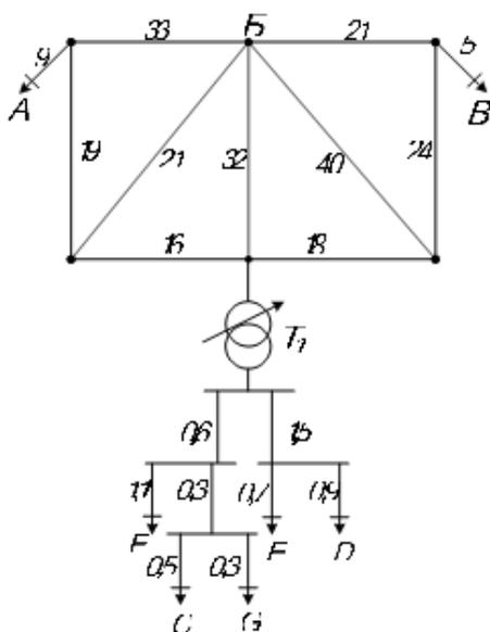
1. Структурная схема электрической сети завода с указанием длин линий (км):
