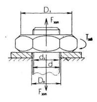
Таким образом, болт находится в сложно-сопряженном состоянии и должен рассчитываться по одной из гипотез прочности.
