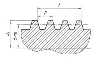
Полученное значение модуля округлить до ближайшего стандартного по ГОСТ 2144-76 (СТ СЭВ 267-76). Ниже приведены значения модулей в наиболее употребительном для червячных передач диапазоне: 2,02 2,5 3,15 4,0 5,0 6,3 8,0 10,0
