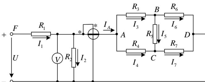
2. Заменить треугольник, состоящий с резисторов  $R_3$ ,  $R_4$ ,  $R_5$  эквивалентной звездой.
