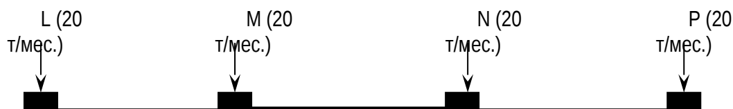
Рисунок 3 - Определение оптимального расположения распределительного склада при равенстве «левого» и «правого» грузооборота пробной точки
