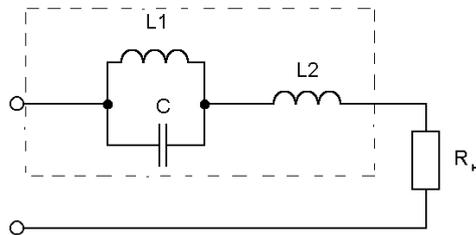
2. Определить действующие значения тока и напряжений на отдельных участках электрической цепи, если  $u=400+282\sin\omega t$ ,  $\omega L = 1/\omega C = 60 \text{ Ом}$ ,  $R=40 \text{ Ом}$ .
