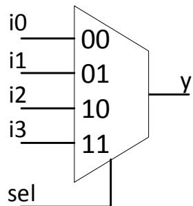
Рисунок 2.6 – Схема мультиплексора 4 в 1
