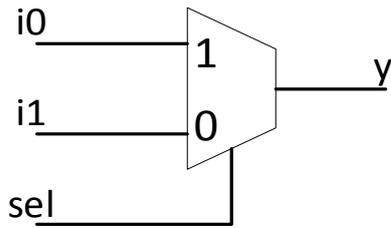
Рисунок 2.3 – Схема мультимплектора 2 в 1
