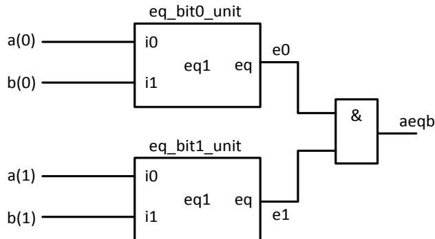
**Рисунок 10** ошибка! Текст указанного стиля в документе отсутствует..2 – Реализация двухразрядной схемы сравнения на основе одноразрядных блоков
