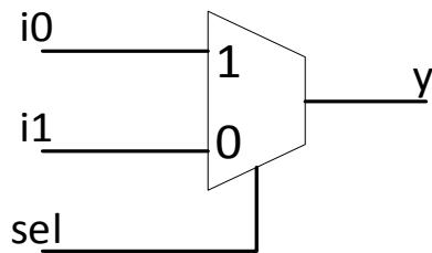
Рисунок 2.3 – Схема мультиплексора 2 в 1
