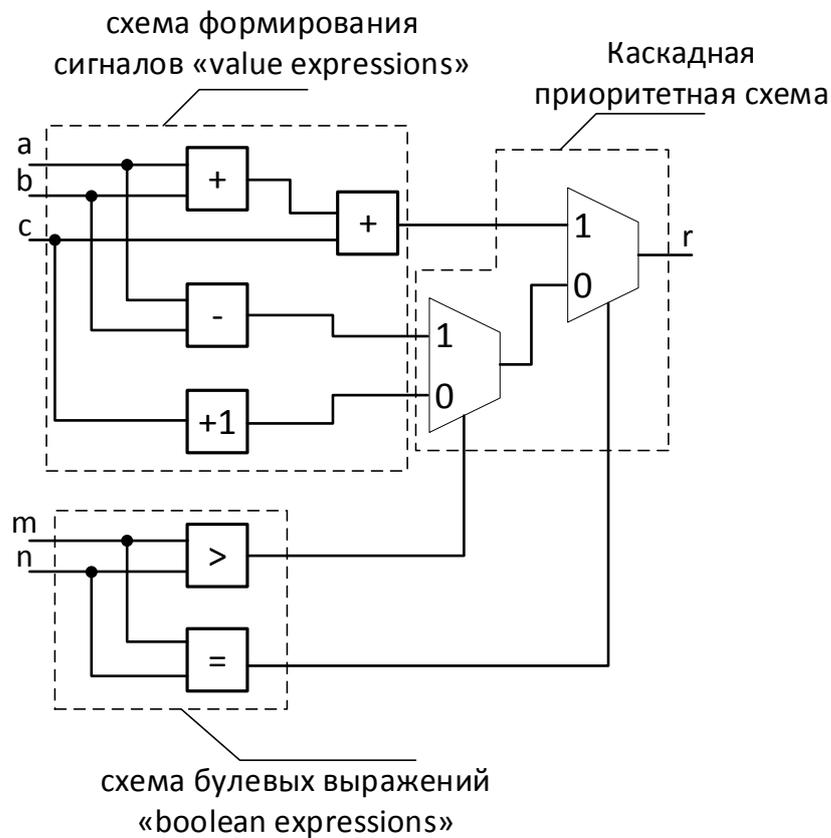
Рисунок 2.4 – Синтезированная схема, реализующая конструкцию «присваивание по условию»
