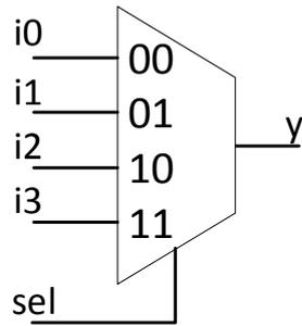
Рисунок 2.6 – Схема мультимплектора 4 в 1
