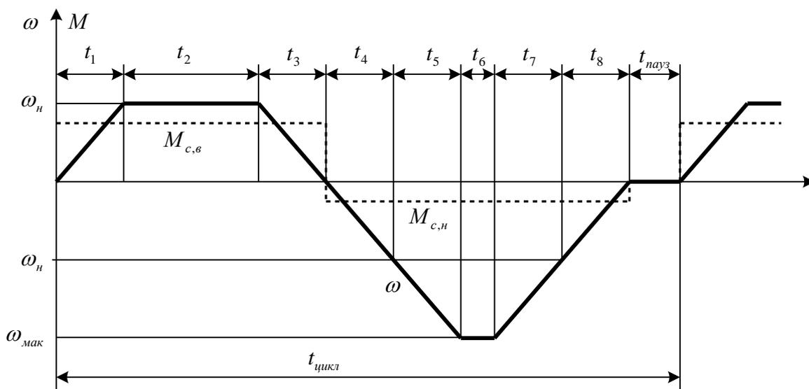
Рис. 1. Тахограмма и зависимость  $M_c = f(t)$  проектируемого электропривода
