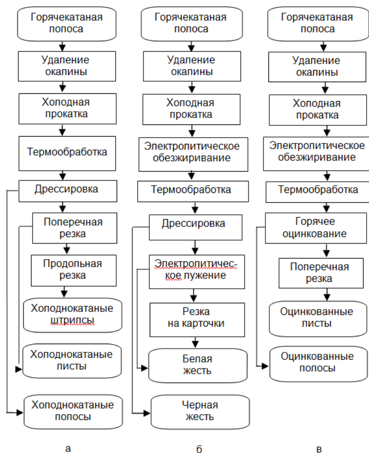
Схемы технологического процесса производства холоднокатаной листовой стали:
