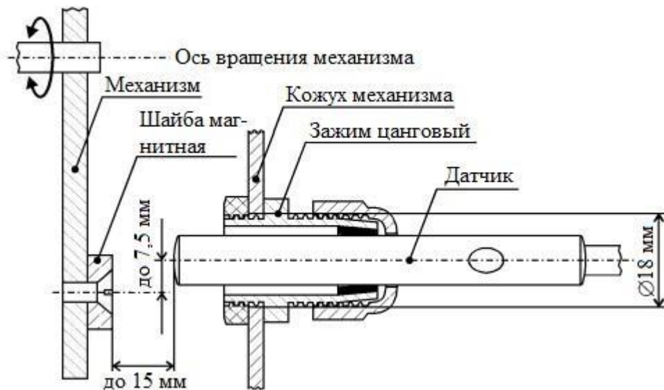
Рис.5. Принцип работы датчика движения
