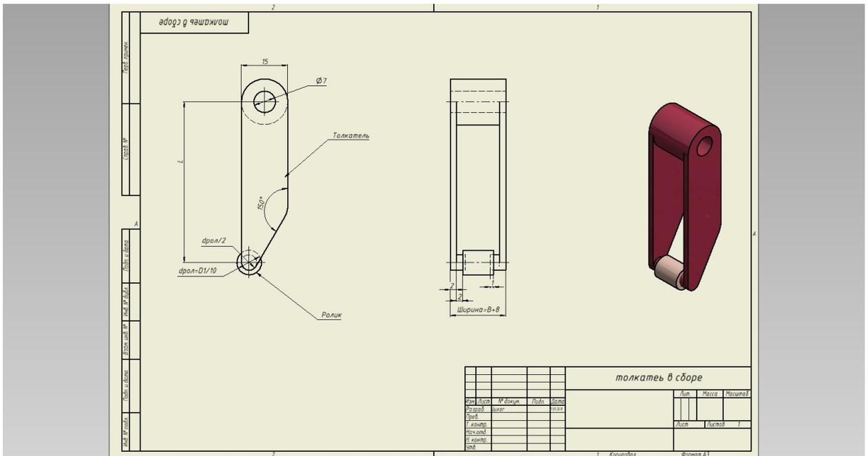
Рисунок 3. Чертеж толкателя с параметрическими зависимостями
