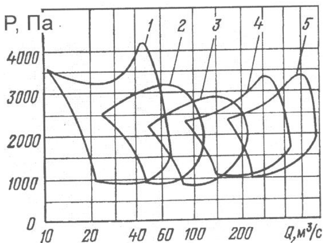
Рис. 4.1. Сводные графики промышленного использования осевых вентиляторов главного проветривания:
