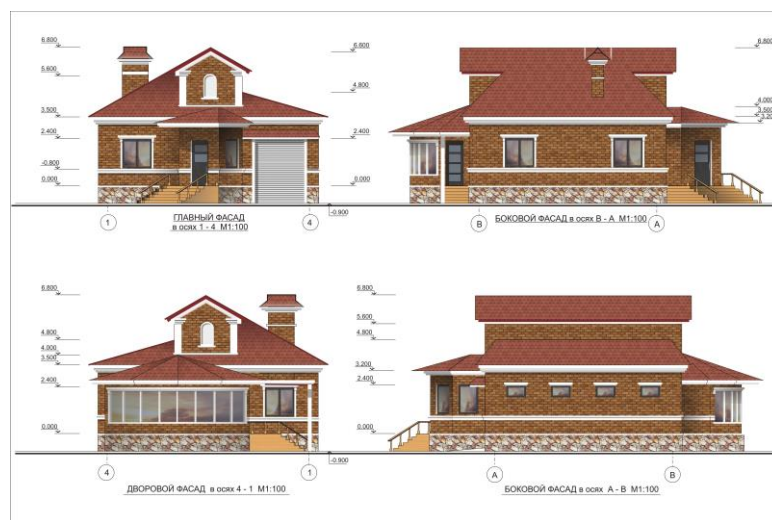
Рис. 5 Выполнение фасадов здания (компьютерная графика)
