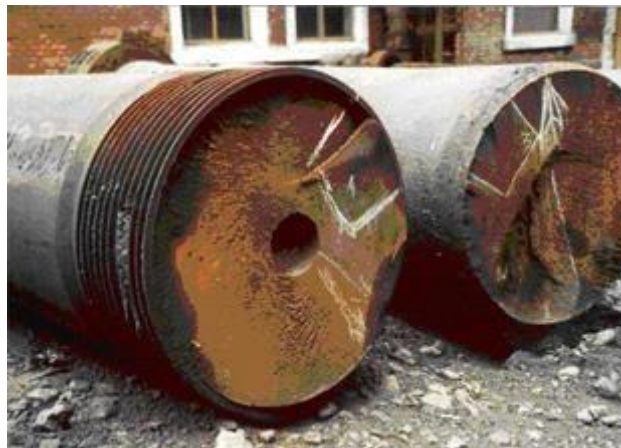
Рис. 2. Поверхности излома разрушенных колонн пресса силой 70 МН для изготовления ж/д колес. Диаметр колонн 600 мм
