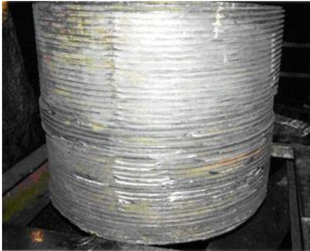
Рис. 3. Разрушение внешней резьбы шенной внутренней резьбы колонны под основанием пресса силой 100 архитравом пресса силой 100 МН для объ- МН для изготовления ж/д колес. Диаметр емной штамповки. Диаметр колонны 800 колонн 830 мм мм
