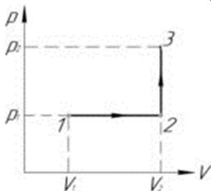
$V_1=2$  л,  $V_2=3$  л,  $p_1=400$  кПа. Найти работу газа, совершенную в процессе 1-2-3 (схема к задаче приведена справа).
