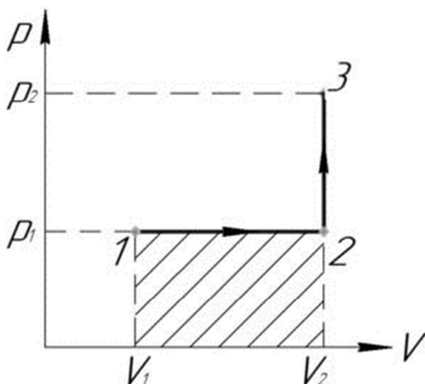
Работа газа  $A$ , совершенная в процессе 1-2-3, равна сумме работ газа в процессах 1-2 и 2-3.
