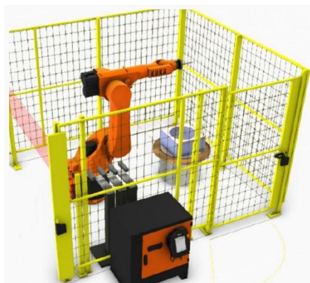
Рисунок 4 – Роботизированная инкрементальная листовая формовка
