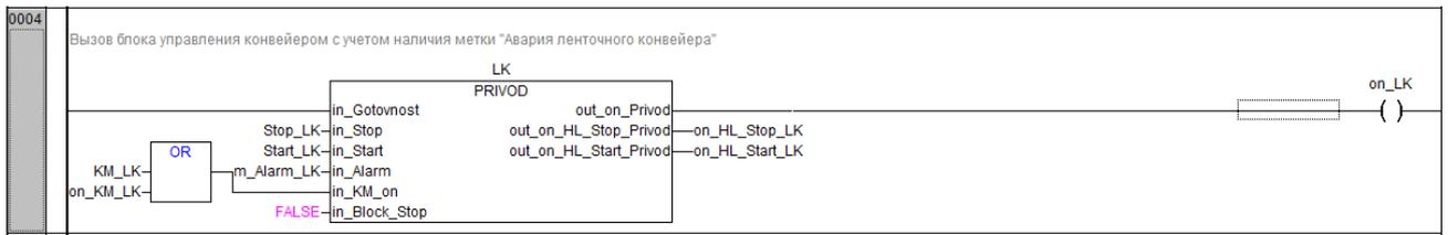
Рис. 15. Фиксация аварии ленточного конвейера
