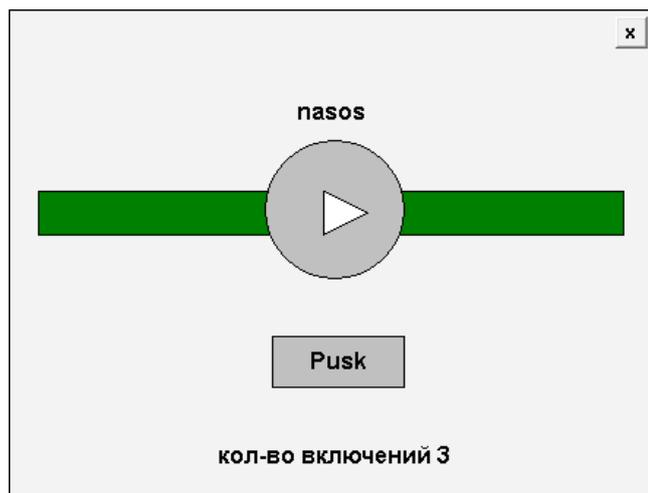
При нажатии на кнопку (**push**), насос (**nasos**) должен включиться и проработать 10 секунд, затем автоматически отключиться.
