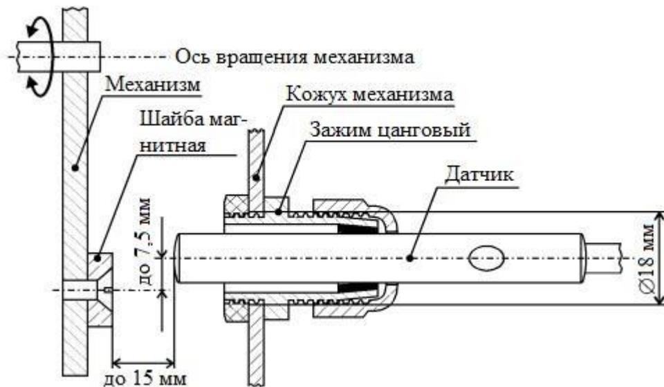
Рис.5. Принцип работы датчика движения
