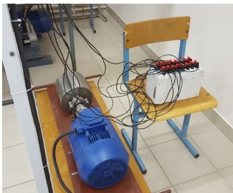
Рис. 4 Лабораторная установка с исследуемым АД
