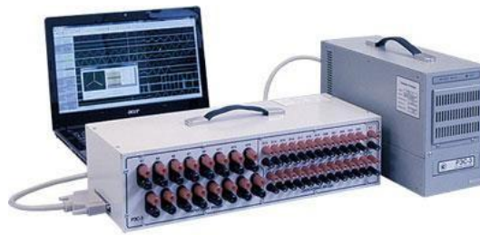
Рис. 5 Многоканальный регистратор РЭС-3 в переносном исполнении
