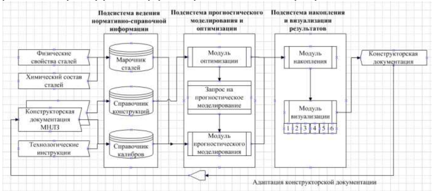
Рис. 5. Схема построения системы автоматизации проектирования
