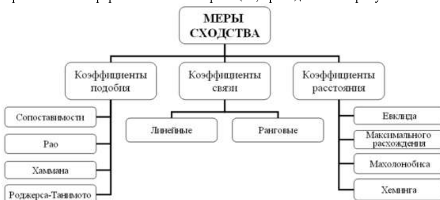
Рис. Схема классификации мер сходства при обработке экспериментальных данных
