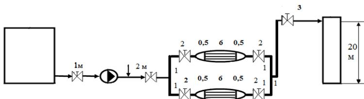
5. Расчёт полной потери напора в трубопроводе по следующим исходным данным: исходная смесь хлороформ - уксусная кислота; массовая доля НК  $x_{нк} = 0,26$ ; расход смеси  $G = 23300$  кг/ч; начальная температура водяного пара  $t_{1н} = 160$  °С; конечная температура водяного пара  $t_{1к} = 160$  °С; начальная температура смеси  $t_{2н} = 30$  °С; конечная температура смеси  $t_{2к} = 61$  °С; давление водяного пара  $P_{вп}=480000$  Па; геометрическая высота подъема  $h_{геом} = 20$  м.
