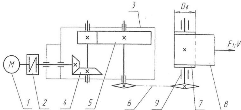
1 – двигатель; 2 – муфта; 3 – редуктор; 4 – коническая передача;
