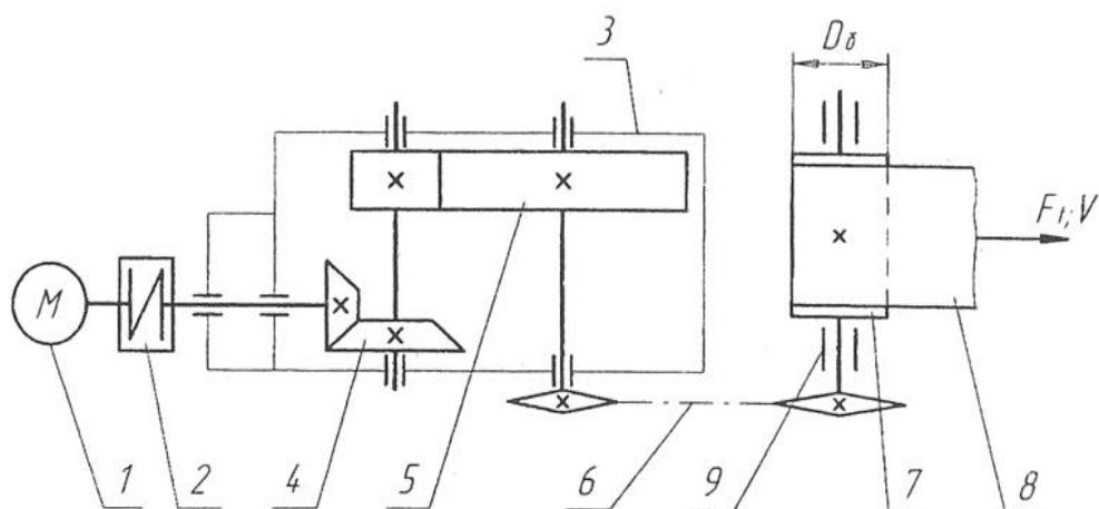
1 – двигатель; 2 – муфта; 3 – редуктор; 4 – коническая передача;
