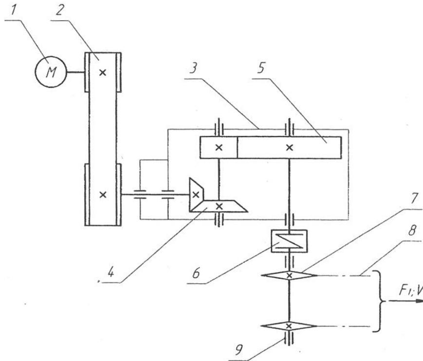
1 – двигатель; 2 – клиноременная передача; 3 – редуктор;
