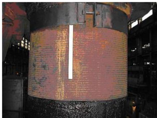
Рис. 4. Общий вид полностью разрушенной внутренней резьбы колонны под архитравом пресса силой 100 МН для объемной штамповки. Диаметр колонны 800 мм
