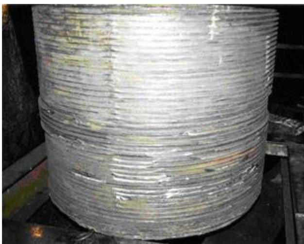
Рис. 3. Разрушение внешней резьбы колонны под основанием пресса силой 100 МН для изготовления ж/д колес. Диаметр колонн 830 мм
