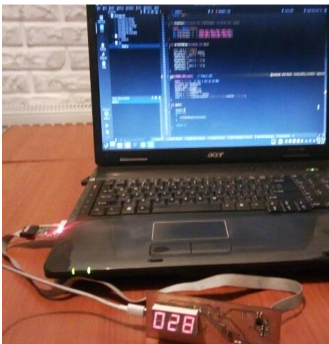
Рис. 24.3. Результат вывода температуры на экран
