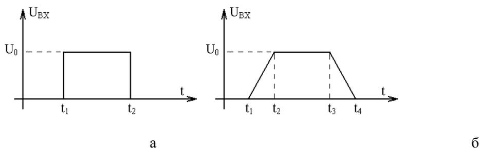
Рис. 1.1. Скачкообразный (а) и линейный (б) закон изменения входного воздействия
