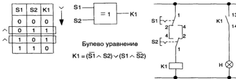
Электрогидравлическая схема с применением логической функции «исключенное «ИЛИ» в схеме (функция НЕ ИЛИ)»
