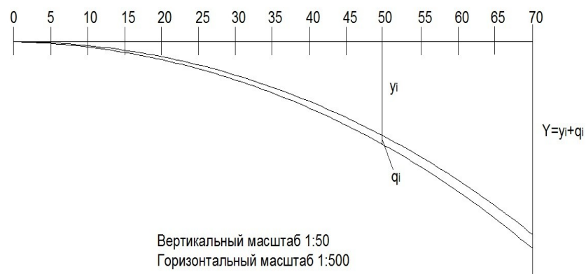
Рис. 10.3. Переходная кривая, построенная разбивкой от линии тангенса
