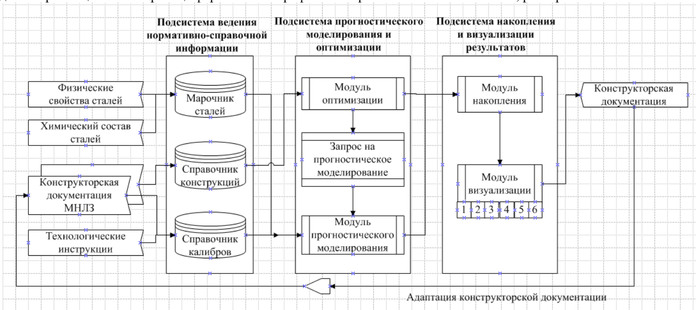
Рис. 5. Схема построения системы автоматизации проектирования
