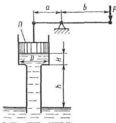
**Задача 2.** Определить давление  $p$  в верхнем цилиндре гидропреобразователя (мультипликатора), если показание манометра, присоединенного к нижнему цилиндру, равно  $p_m = 0,48$  МПа. Поршни перемещаются вверх, причем сила трения составляет 10% от силы давления жидкости на нижний поршень. Вес поршней  $G = 4$  кН. Диаметры поршней:  $D = 400$  мм,  $d = 100$  мм; высота  $H = 2,5$  м; плотность масла  $\rho = 900$  кг/м<sup>3</sup>.
