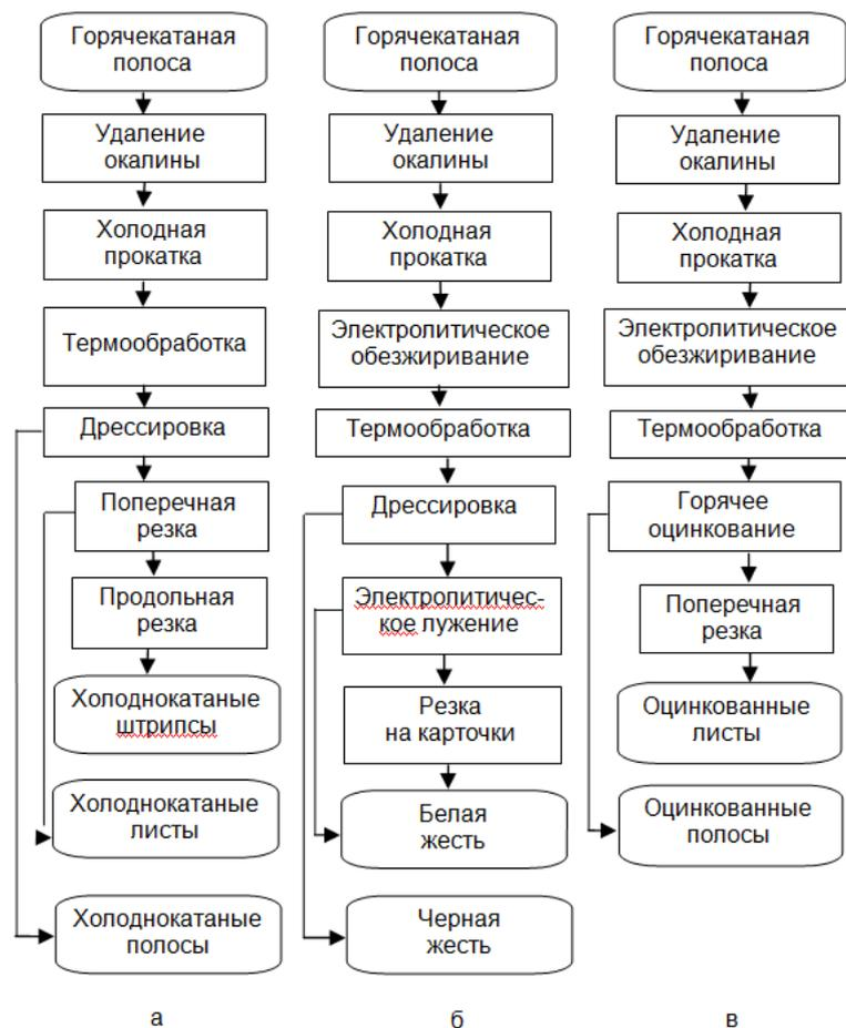
Схемы технологического процесса производства
