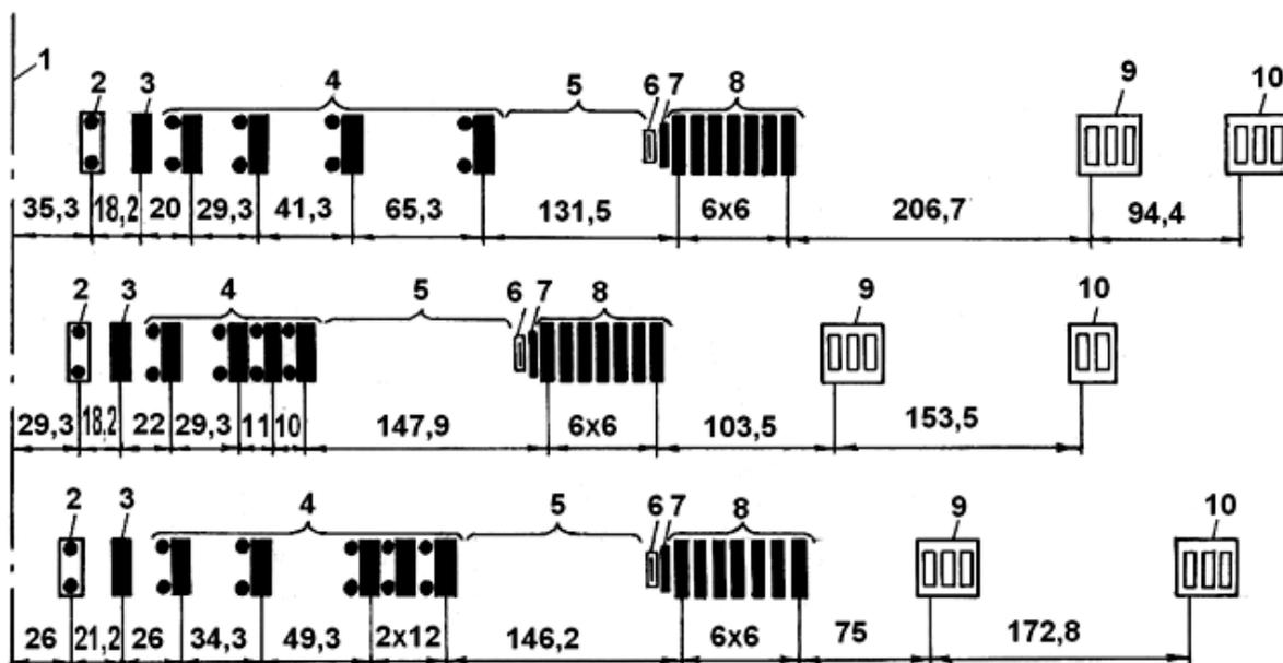
Компоновка непрерывных станов горячей прокатки:
