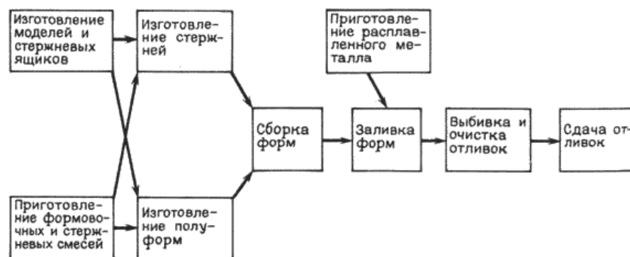
Схема технологического процесса изготовления отливок в песчаных формах Выполнение работы
