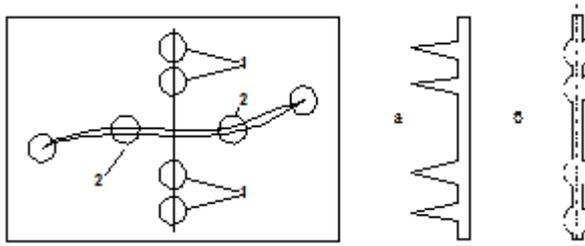
Рис. 2 – Сшивание трещин
