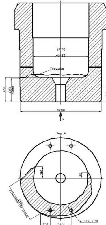
Рис.3 – Трещина в днище сварнокованого цилиндра силой 50 МН
