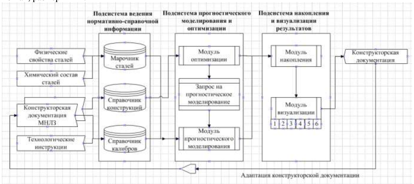
Рис. 5. Схема построения системы автоматизации проектирования
