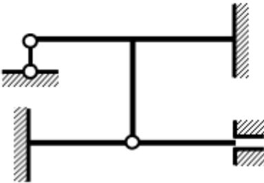
3. Построить эпюру изгибающих моментов от заданной нагрузки. Жесткости сечений вертикальных стержней  $EI$ , горизонтальных  $2EI$ .
