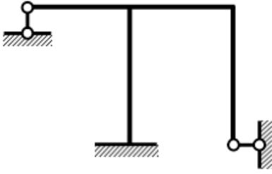
2. Определить степень кинематической неопределимости и выбрать основную систему метода перемещения.
