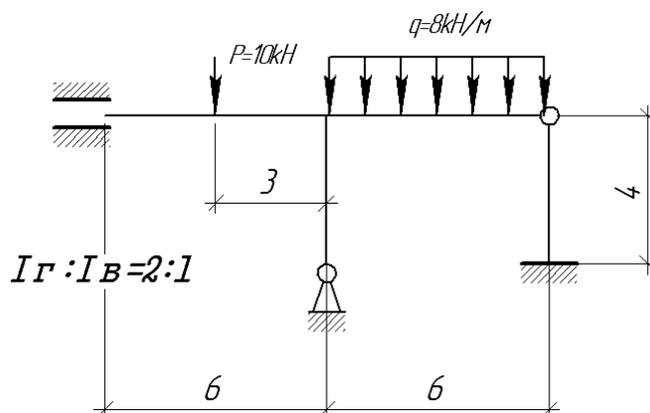
Задача 2. Расчет статически неопределимой балки методом перемещения:
